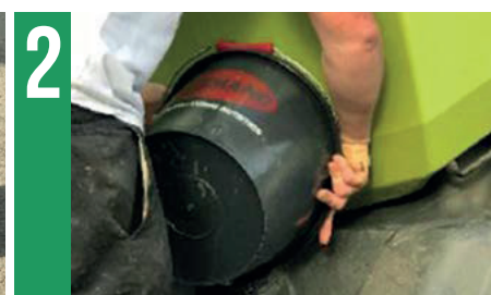
2 Incorporation dans le système pré équipé sur l'ensileuse + complément d'eau
